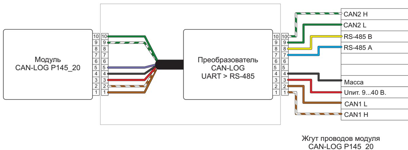
Жгут проводов с разъемом (мама) подключается к модулю CAN-LOG, в разъем (папа) преобразователя подключается штатный жгут проводов модуля (см. схему подключения).
